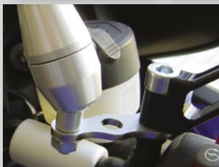
Supporto Forato: Aiuta di fissare il MultiPod "Lungo" (immagine) o "Corto" MultiPod su qualsiasi posizione desiderata.
